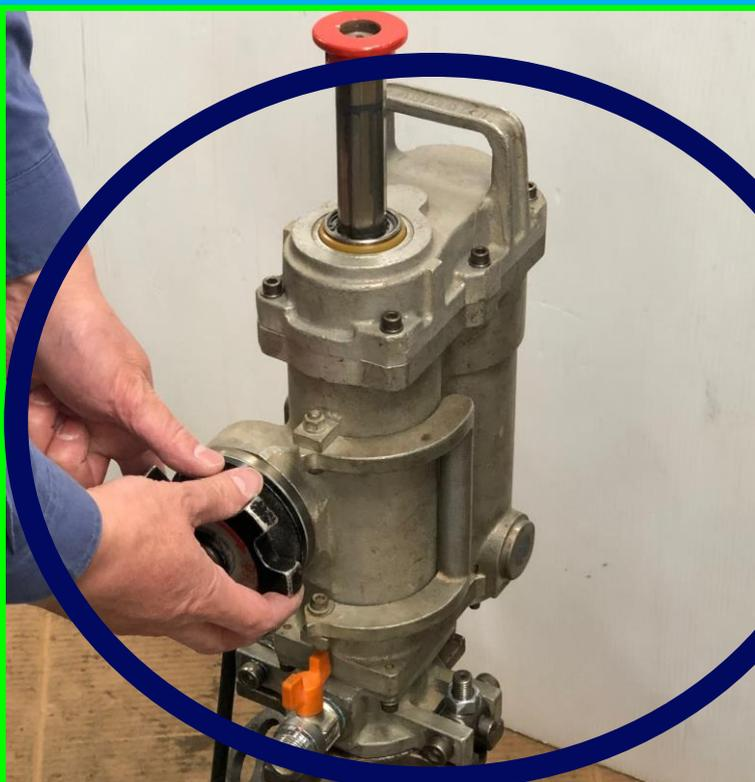
穿孔作業中は回転しているスピンドルに絶対に触れないでください。
