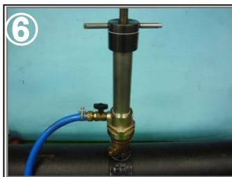
⑥ 排水コックに排水ホースを取付けます。穿孔時は必ず排水してください。
