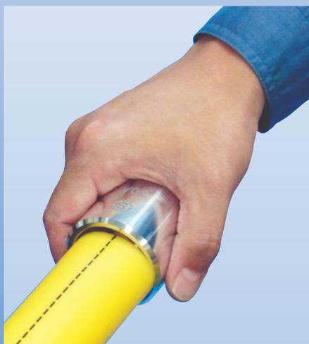
スクレップエリアマーカに差込めない管は、変形を直して差込めるようにすることで、継手にも差込める管にすることができます。
