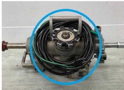
ファルコン本体に電源コードを巻き付けて保管すると、コード根元が引っ張られその隙間（赤矢印部分）から浸水し、故障・内部の錆発生の原因となります。画像右側のように、コードを緩やかに巻き、ハンドルに掛けて保管します。
