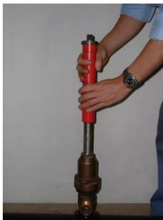
コアが穿孔穴に挿入されたあと、コアのツバが管表面に当たり止まる。(図B)
